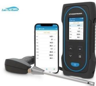
Tous les mois, nous réalisons en interne des mesures des niveaux de monoxyde et de dioxyde de carbone à l'aide d'un outil de contrôle portable, pour vérifier que l'appareil de crémation est correctement réglé.
